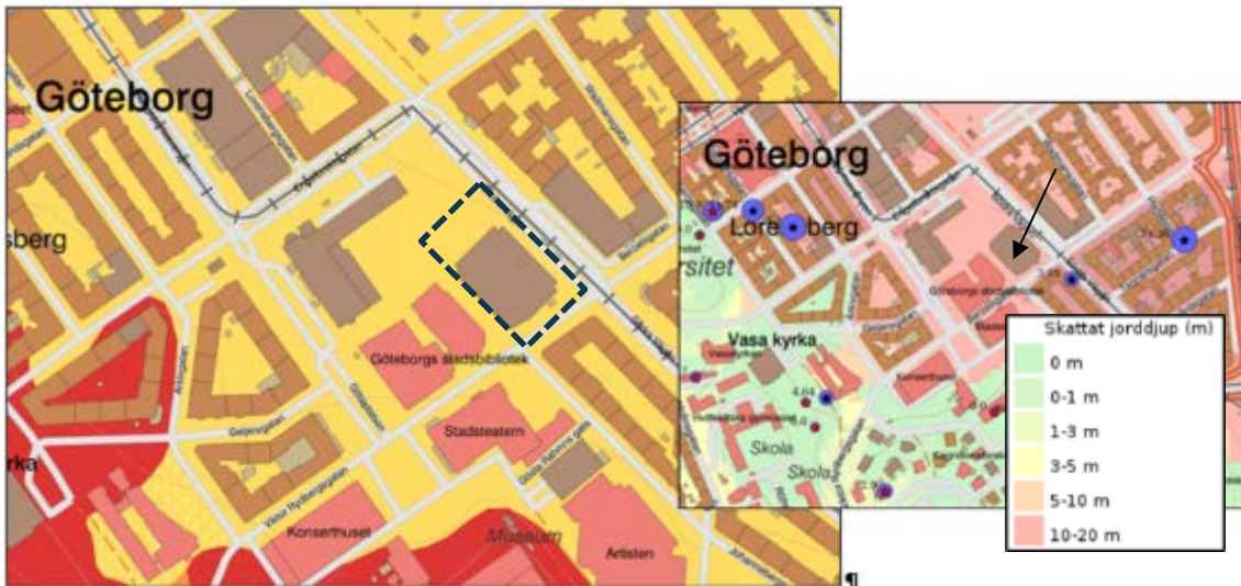
Figur 3. Geologisk karta över området (SGU). Undersökningsområdet är markerat med svart streckad linje. Gul färg=lera. Infällt återfinns jorddjup.
